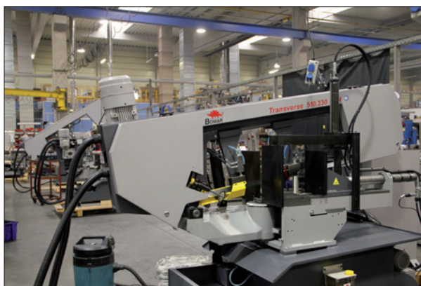
Obr. 1. Poloautomatická pásová pila Transverse 510.330 DGH od firmy Bomar
