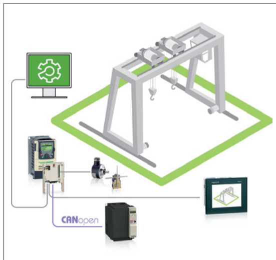
Obr. 4. Schéma řízení jeřábů pomocí softwaru SoMachine s knihovnou aplikačních funkčních bloků (AFB)
