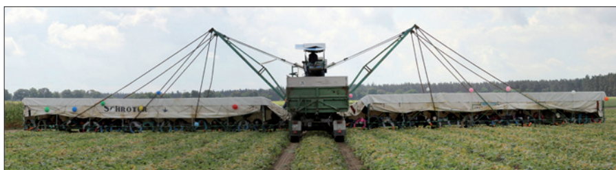
Obr. 1. Současný sklízecí stroj veze nad polem najednou až 30 pracovníků ručně trhajících okurky (foto: Leibnizův ústav ATB)
