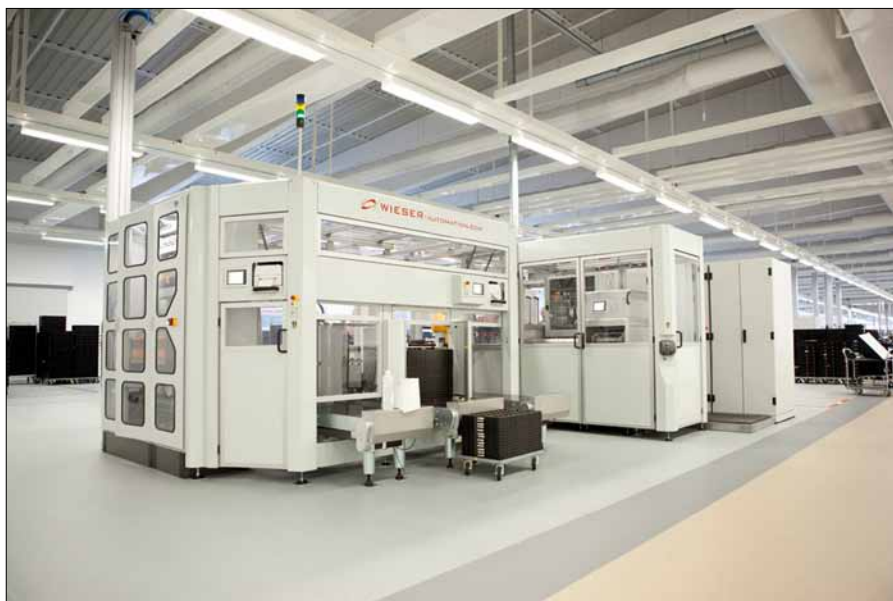
Obr. 1. Linka pro sestavování analogových modulů X20
