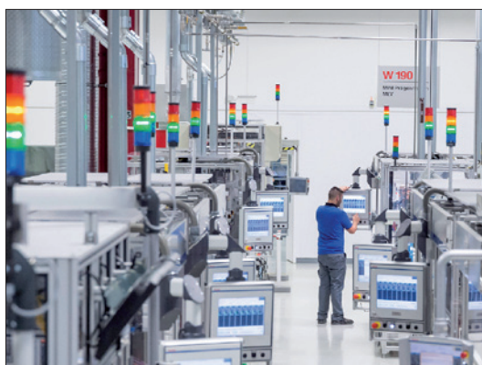
Obr. 1. Nejmodernější výrobní linky se na základě stavových údajů získávaných z inteligentních multifunkčních snímačů nesených samotnými produkty sledují a organizují v podstatě samy (zdroj: Edacentrum)
