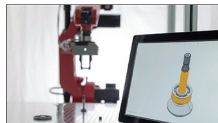
Obr. 2. Postup montáže se interaktivně určuje s použitím modelů komponent vytvořených v prostředí CAD (foto: Fortiss)
