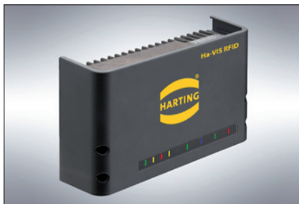
Obr. 3. Vhodnou čtečkou může být Ha-VIS RF-R500, usnadňující integraci dat z transpondérů do řídicího systému
