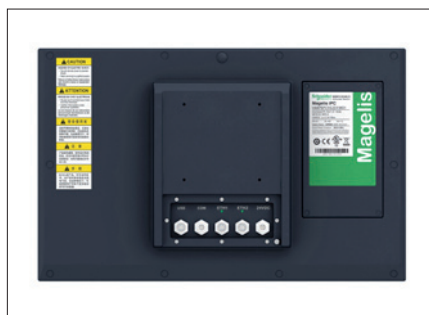
Obr. 3. Magelis HMIPEP s krytím IP66 ze všech stran má konektory komunikačních sítí a napájení opatřené speciálními krytkami
