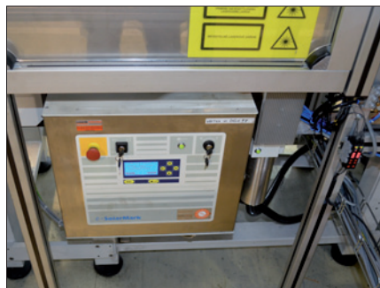
Obr. 5. Řídicí jednotka CU0 se používá tehdy, je-li značící zařízení ovládáno z PLC nebo PC
