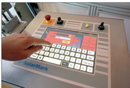
Obr. 4. Řídicí jednotka CU2 zařízení Solaris e-SolarMark FLS
