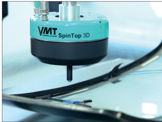
Obr. 3. Měřicí sonda SpinTop 3D umožňuje spolehlivě kontrolovat kvalitu lepených spojů (foto: VMT)
