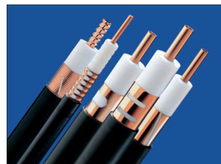
Obr. 2. Vyzařovací kabely obsahují sloty – „okénka“, která vyzařují signál dané frekvence a všechny ostatní frekvence odstíní, aby nedocházelo k rušení.
