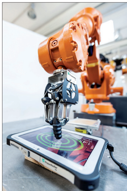
Obr. 1. Průmyslový robot upravený pro účely ověřování odolnosti dotykových obrazovek proti provozním dotykům (foto: Fraunhofer IPA)
