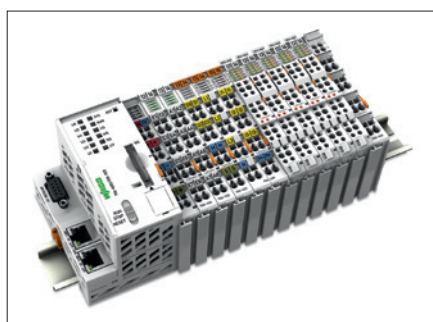
Obr. 1. Jako hardware systému WAGO Lighting Management se používá procesorová jednotka PFC200 s moduly sběrnice DALI, papř. dalšími I/O moduly (zde např. modul 750-495, který měří spotřebu v třífázové síti)
