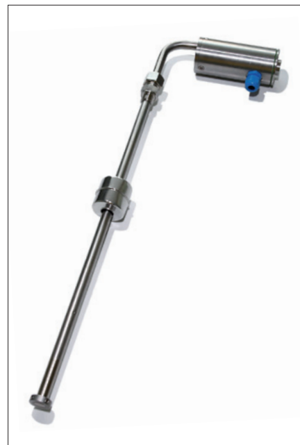
Obr. 4. Hladinoměr Torrix v provedení Torrix 90 s elektronikou situovanou kolmo k sondě (vhodný např. pro stísněné prostory)
