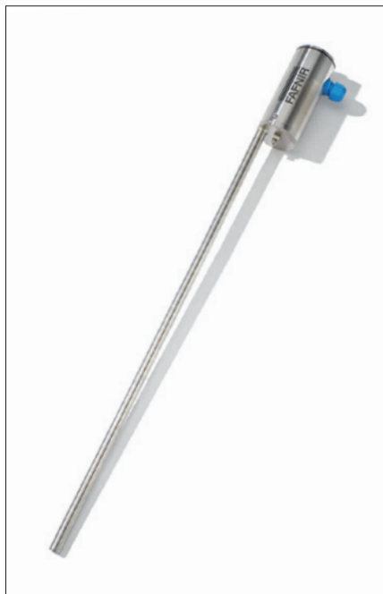
Obr. 3. Hladinoměr Torrix v provedení Torrix bypass (montuje se přichytnými pásky na povrch obtokového stavoznaku)
