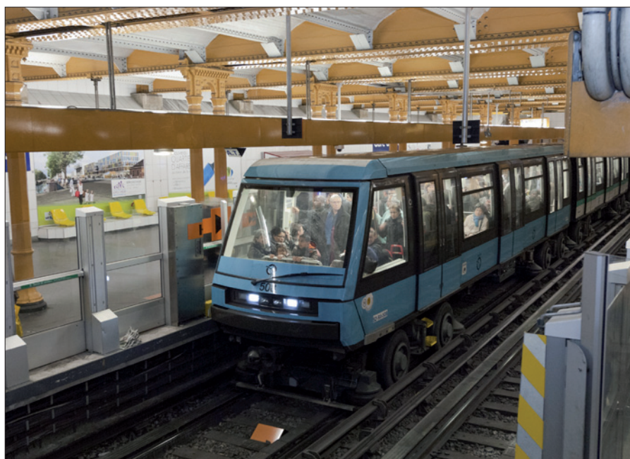
Obr. 1. Linka 1 pařížského metra vybavená systémem Trainguard MT od společnosti Siemens je v plně automatickém provozu a její soupravy jezdí bez strojvedoucích
