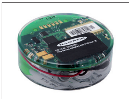
Obr. 1. Bezdrátový uzel M-Gage
