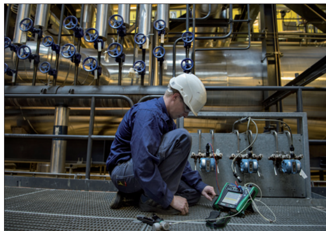
Obr. 2. Při kalibracích v provozu je nepohodlné postupovat podle vytištěné uživatelské příručky a výsledky manuálně zaznamenávat do protokolu o měření – dokumentační kalibrátor provádí technika postupem kalibrace, výsledky automaticky zaznamenává do své paměti a po připojení je automaticky přeneše do databáze kalibrací
