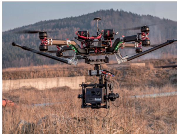
Obr. 2. Dron s instalovanými termokamerami
