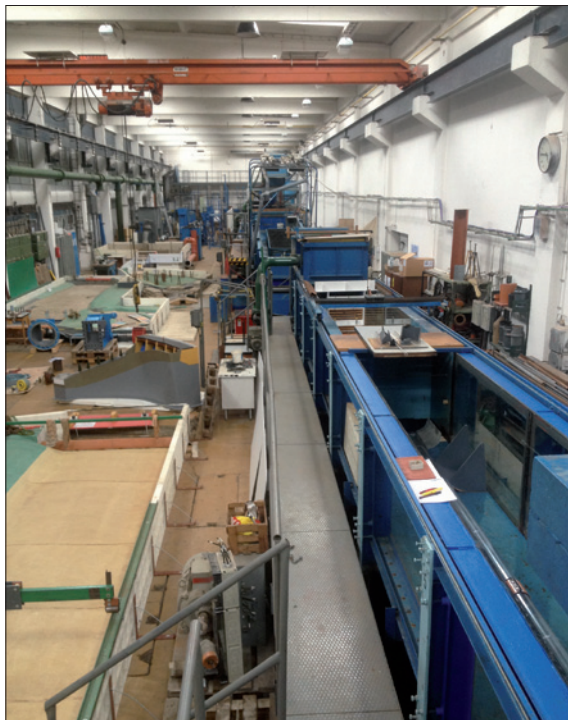
Obr. 1. Fyzický model vodního díla na katedře hydrauliky FSv ČVUT
