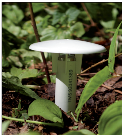
Obr. 3. Autonomní mikroklimatická stanice TMS pro měření půdní vlhkosti a teploty s integrovaným záznamníkem dat (TOMST)
