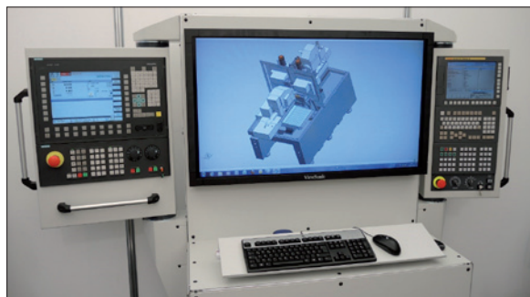
Obr. 3. Funkce řídicího systému jsou dříve než na reálném stroji ověřovány na jeho virtuálním modelu
