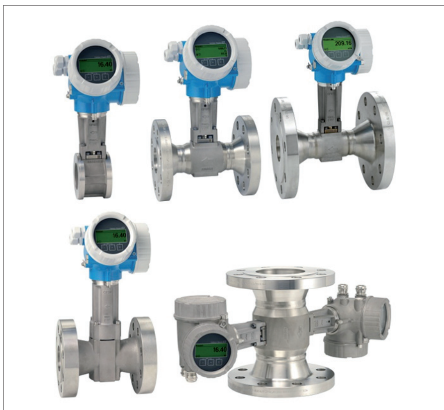
Obr. 1. Horní řada zleva: Prowirl D 200 (mezipřírubové provedení), Prowirl F 200 (standardní verze), Prowirl R 200 (provedení s vnitřní redukcí světlosti potrubí); dolní řada: vlevo Prowirl O 200 (provedení pro vysoké tlaky), vpravo Prowirl F 200 (provedení se dvěma senzory pro velkou funkční bezpečnost)
