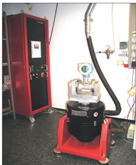
Obr. 3. Vírový průtokoměr Prowirl na zkušební stoličce, kde se testuje jeho odolnost proti vibracím
