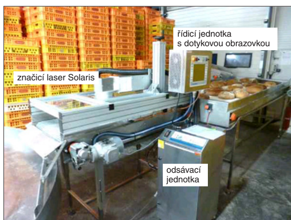
Obr. 1. Pracoviště pro laserové značení chleba je zařazeno mezi dopravníky
