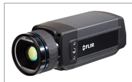
Obr. 4. Termokamera FLIR A615 pro automatizaci a strojové vidění (rozlišení 640 × 480 pixelů, teplotní citlivost 50 mK, možnost tvorby vlastních aplikací pomocí SmartVision SDK či v LabView)
