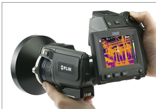
Obr. 1. Termokamera FLIR T640 vybavená přídavným teleobjektivem pro měření vzdálených prvků na rozvodech vysokého napětí (citlivost 35 mK, rozlišení 640 × 480 pixelů, rozsah -40 až 3 000 °C záznam radiometrického videa, funkce MSX a další funkce)
