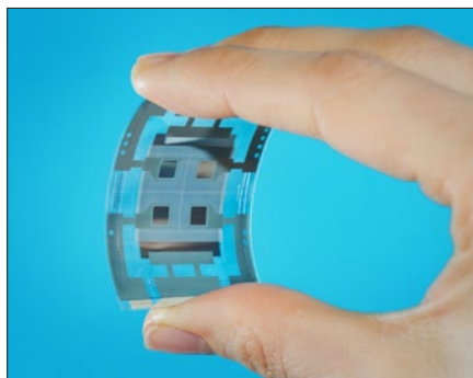
Obr. 1. Organické diody nanesené na pružné polymerové fólii (foto: Fraunhofer COMEDD)
