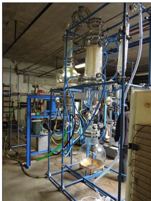
Obr. 5. Výzkumný program Alternativní zdroje energie se zaměřuje na zpracování kapalných i tuhých odpadních tuků na kvalitní bionaftu
