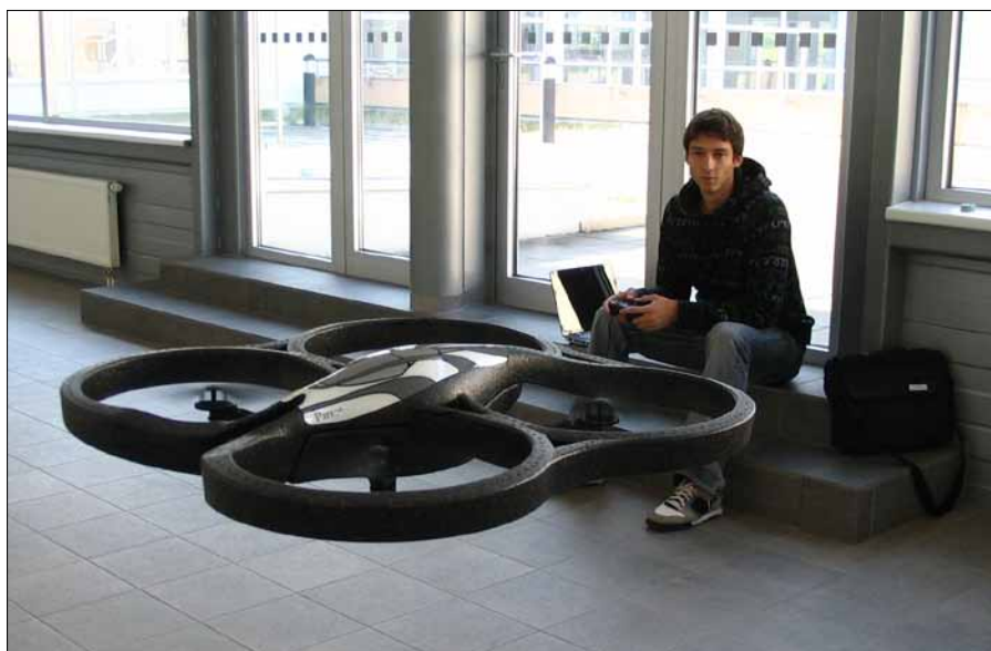
Obr. 3. Quadro-copter AR.Drone řízený prostřednictvím počítače za letu v interiéru
