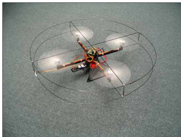
Obr. 1. Quadro-copter opatřený ochranným rámem z prutů z uhlíkového kompozitního materiálu
