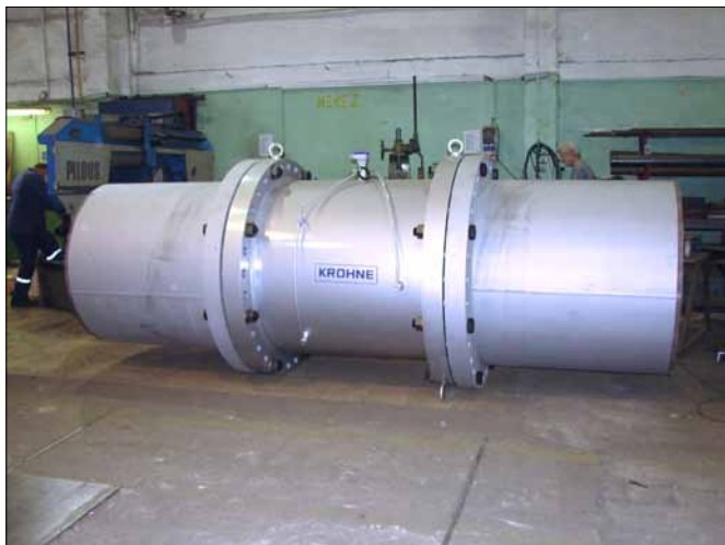
Obr. 3. Ultrazvukový průtokoměr Krohne UFM 3030 DN 1200 s přírodními úseky potrubí – příprava k montáži
