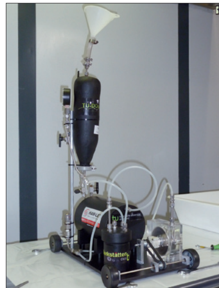
Obr. 2. Součástí kongresu byly i soutěže pro studenty, které mají posílit jejich zájem o studium chemie; na obrázku je vítězné vozidlo v soutěži ChemCar – soutěžní vozidla jsou poháněna výhradně chemickou reakcí a úkolem je ujet co nejpřesněji zadanou vzdálenost bez možnosti vozítka během jízdy brzdít nebo jinak řídit; jedinou možností, jak dojezd ovlivnit, je množství reagujících látek (vlevo vítězné vozidlo, vpravo autoři z TU Dortmund)
