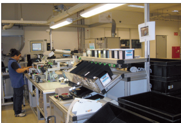
Obr. 3. Balící pracoviště vybavené systémem Poka Yoke: indikátory u jednotlivých zásobníků hlídají, zda je zabalen kompletní přístroj se všemi komponentami a dokumenty (záruční list, schéma zapojení apod.)
