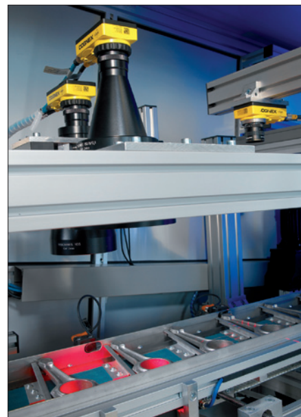
Obr. 3. Systémy pro strojové vidění Cognex In-Sight 5401 a 5403 kontrolují rozměry a odchylky tvaru a polohy ojníc
