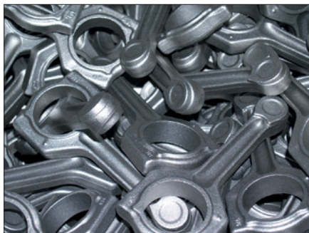
Obr. 1. Kontrolované díly – výkovky ojníc
