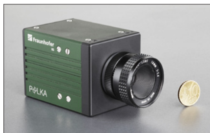
Obr. 2. Kamera Polka ke snímání polarizovaného obrazu (foto: Fraunhofer IIS)
