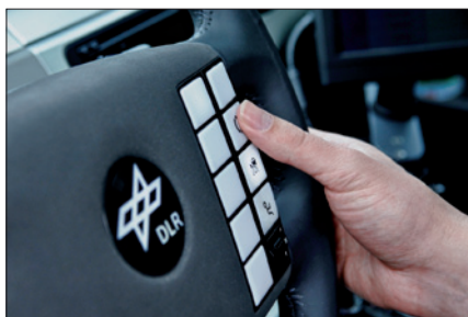
Obr. 3. Řidič zvolí stiskem tlačítka stupeň automatizace jízdy (foto: HAVEIT)
