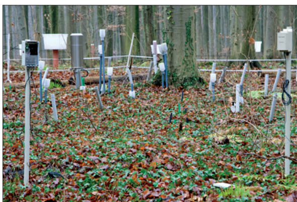
Obr. 1. Snímače zapojené v bezdrátové síti umožňují efektivně sledovat mikroklima v lese (foto: Fraunhofer IMS)
