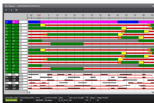
Obr. 3. Pásový diagram zobrazení stavu signálních skupin a detektorů dané křižovatky
