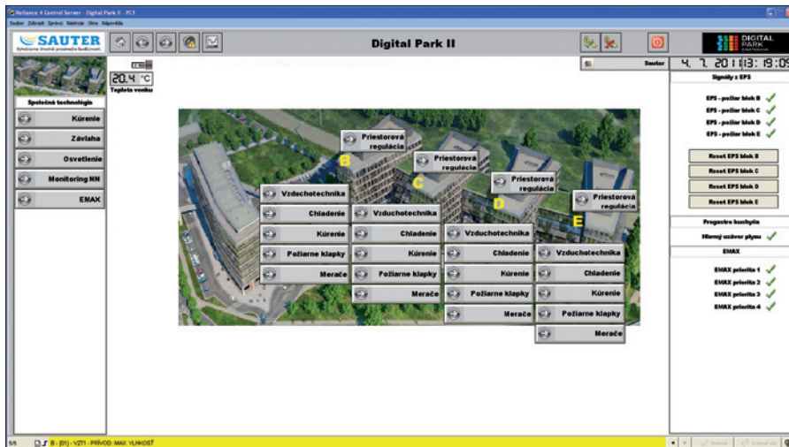
Obr. 3. Přehledová obrazovka řízení a monitorování komplexu Digital Park Einsteinova, Bratislava
