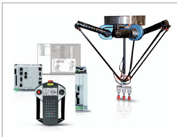
Obr. 1. KeMotion Packaging je systém pro úlohy pick & place a paletizaci
