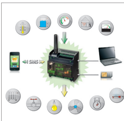
Obr. 1. Moduly MIRO GSM lze použít k dálkovému ovládní a monitorování četných zařízení
