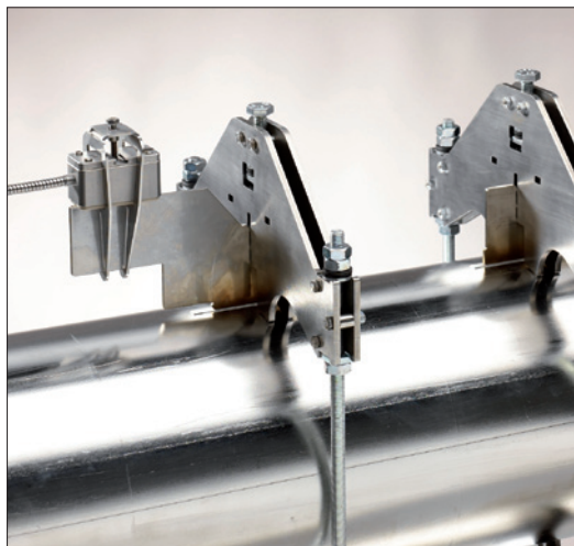
Obr. 3. Příklad použití průtokoměru Fluxus ADM s nastavci WaveInjector
