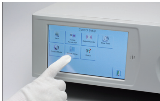
Obr. 4. Ovládání kalibrátoru PACE 6000 z dotykového displeje
