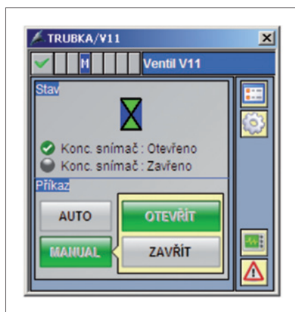
Obr. 2. Příklad faceplate – ovládání ventilu
