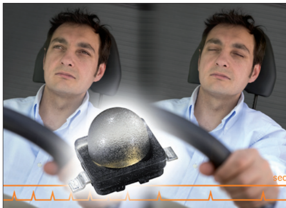
Obr. 2. Nová infračervená LED včas upozorní řidiče na nebezpečí mikrosnávkou
