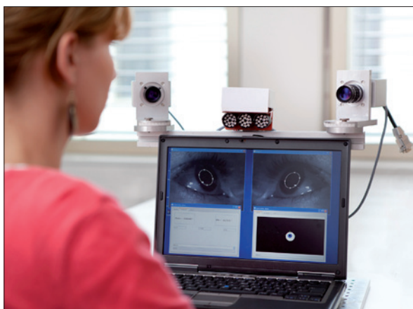
Obr. 1. Zkoušky systému pro sledování pohybu očí Eye-Tracker v laboratoři (foto: Fraunhofer IDMT)
