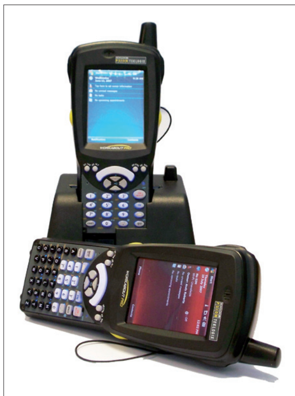
Obr. 1. Mobilní terminál Psion Workabout pracuje jako snímač čárových kódů a prostřednictvím dokovací stanice přenáší načtená data do podnikové sítě
