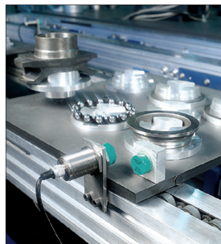
Obr. 2. RFID pro identifikaci tzv. inteligentních palet na výrobní lince
