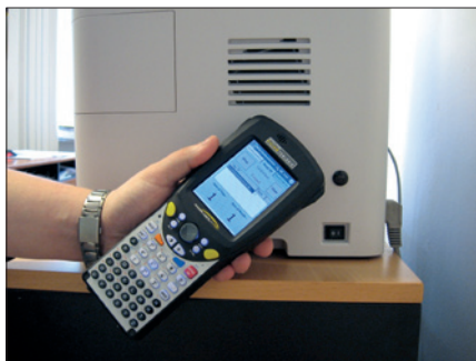
Obr. 1. Snímání tagu mobilní čtečkou RFID
