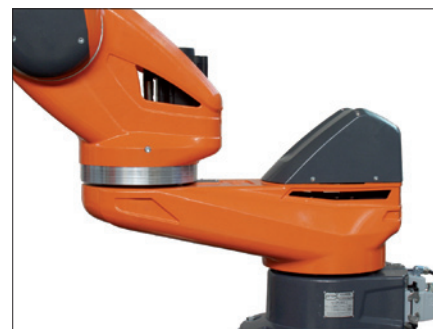
Obr. 3. Robot se zřetelně viditelnou excentrickou osou (sedmá osa)
