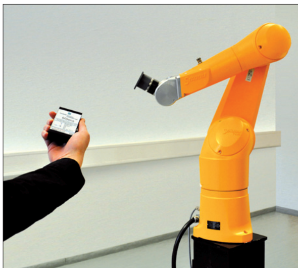
Obr. 1. Pohyb ramena robotu lze snadno řídit malým zadávacím přístrojem: pohybuje-li obsluha paží, ve níž drží zadávací přístroj, robot tento pohyb sleduje (foto: Fraunhofer IPA)
