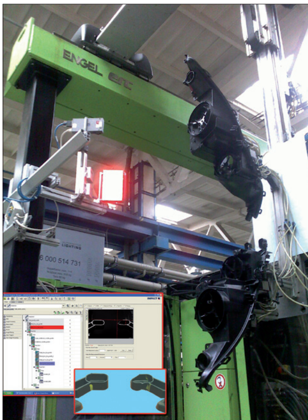
Obr. 1. Totální kontrola kvality kritických částí vstřikovaného plastového dílu
