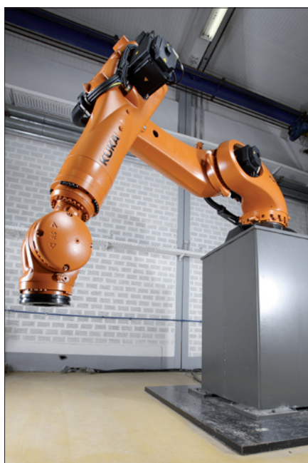
Obr. 1. Robot Quantec v konzolovém provedení, vhodný pro integraci se vstříkovacím, obráběcím nebo tlakovým licím strojem
