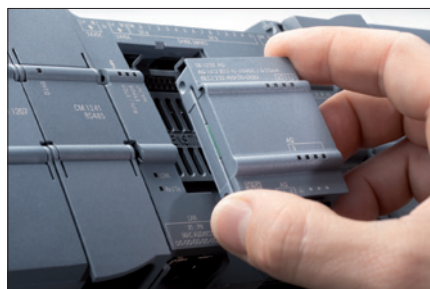
Obr. 2. Signálový modul k vložení přímo do základní jednotky (typ SB 1232 AQ: \pm 10 V/0 až 20 mA)
