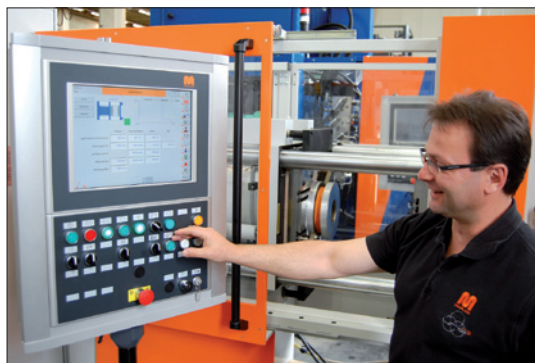
Obr. 2. Vizualizace běží na ergonomicky nastavitelné speciálně zkonstruované ovládací jednotce s operátorským panelem B&R AP900 s 15" dotykovým displejem; systém zahrnuje ovládání i diagnostiku, čímž je opět dosaženo vyšší úrovně komfortu při ovládání stroje
